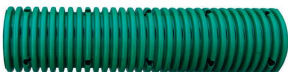
I prodotti per infiltrazione sono dotati di un tubo perforato con tre file di fori del diametro di 15 mm disposti a 120° e separati 100 mm longitudinalmente
