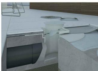
È l'unico sistema di scarichi capace di assicurare l'assoluta continuità tra l'impermeabilizzazione e gli accessori per la canalizzazione dell'acqua: grazie al processo di termo-fusione tra il fazzoletto in tessuto non tessuto o in fibra di vetro e la flangia del chiusino evita il pericolo di infiltrazioni in corrispondenza degli scarichi.
