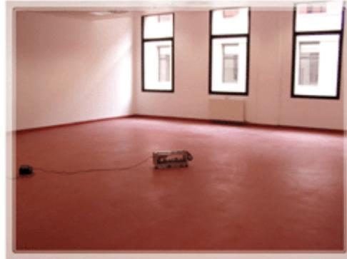
fig.1 - Misura del livello del calpestio:
