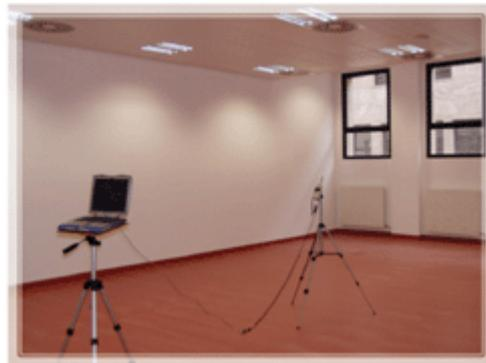
fig.2 - Misura del livello del calpestio:
